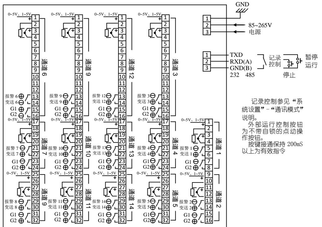
图 4.3 3-14 (L2 外形尺寸) 通道产品接线端子排布
