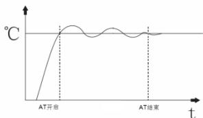
不同的控制系统 PID 参数也不相同.仪表在出厂时预置了一组控制参数,如果控制效果不能符合工艺要求,请启动自整定功能重新整定参数即可.
