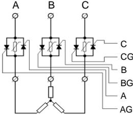
图 13: C5 型应用三相三线制移相触发
